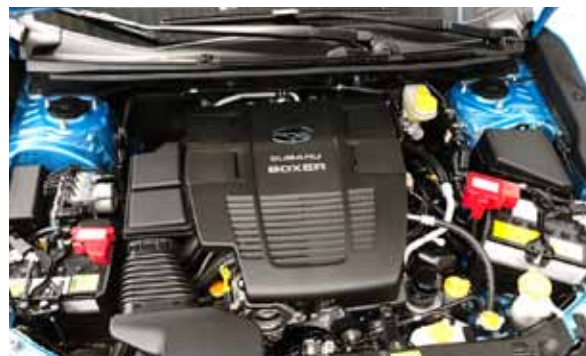
Pohled pod kapotu Subaru XV e-Boxer ukazuje dvojici 12V akumulátorů. Standardní akumulátor pro palubní elektrickou soustavu doplňuje druhý pro výkonný startér-generátor
