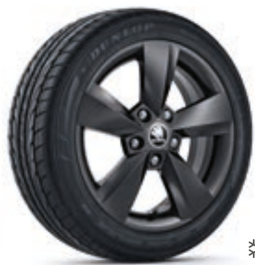
Nanuq 57A 071 496B FL8 Kolo z lehké slitiny 6J × 16" ET43 pro pneumatiky s rozměry 215/60 R16 (4×2, 4×4) a 225/60 R16 (4×4) v černé metalické barvě ŠKODA Originální příslušenství
