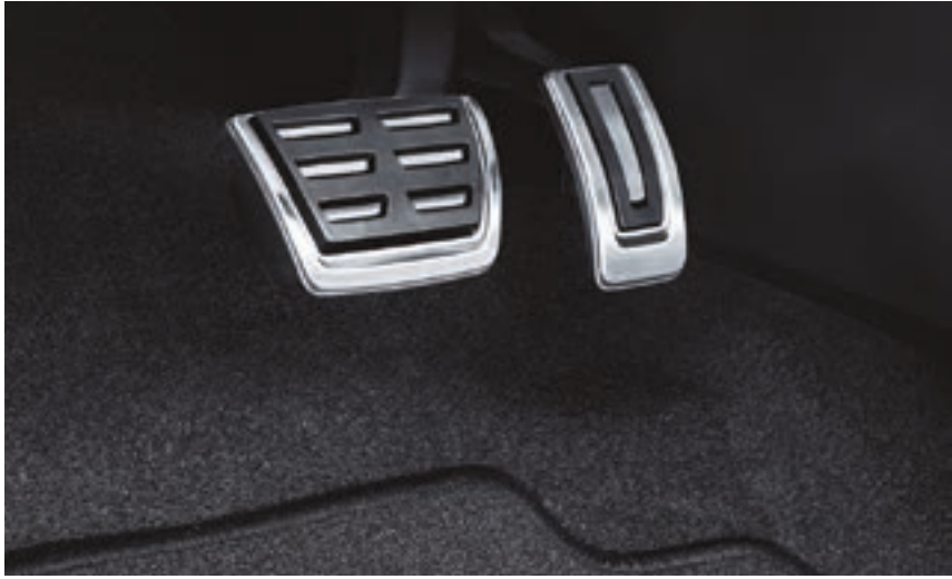
Kryty pedálů z ušlechtilé oceli ŠKODA Originální příslušenství Pro vozy s automatickou převodovkou (5E1 064 205); s manuální převodovkou (5E1 064 200)
