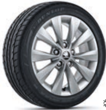
Castor 57A 071 496 8Z8 Kolo z lehké slitiny 6J × 16" ET43 pro pneumatiky s rozměry 215/60 R16 (4×2, 4×4) a 225/60 R16 (4×4) ve stříbrné metalické barvě ŠKODA Originální příslušenství
