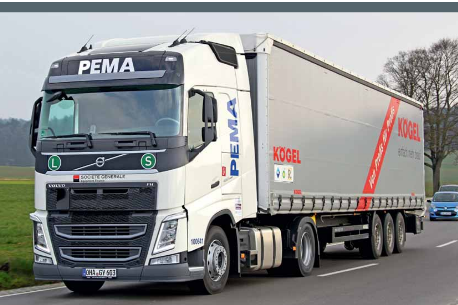
VOLVO v modernom dizajne pôsobí aj s nenalakovaným spojlerom atraktívne. Prívody chladiaceho vzduchu sú kapotované a pôsobia oveľa decentnejšie než v MANe.
