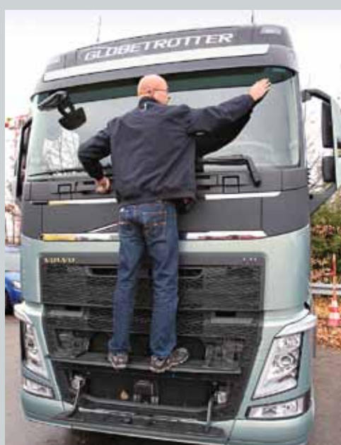
Přístup k přednímu sklu pomocí dvou širokých sklopných stupátek a velkých madel je příkladný.
