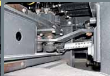
Tyče řízení jsou náročné na údržbu.
