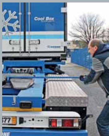
Návěs je možné spojit pouze s uzamčenou točnou.
