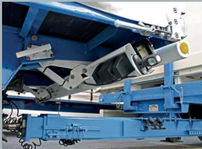
Přestavba na točnou návěs: nízko uložené napojení na střední závěs.
