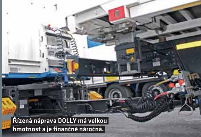
Tyče řízení jsou náročné na údržbu.
