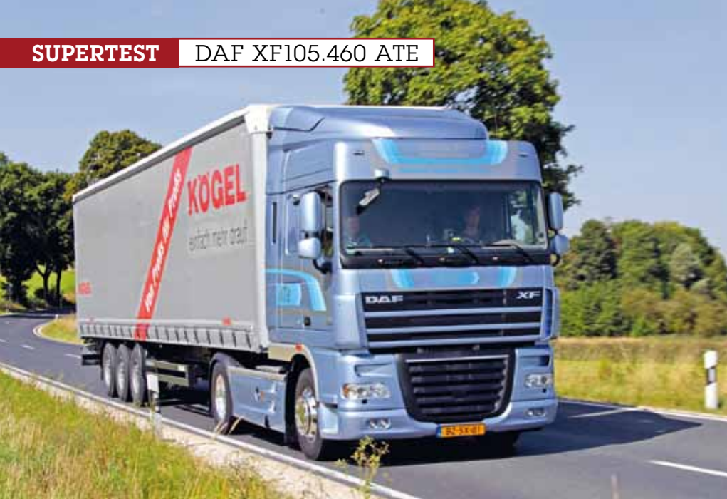
SPOŘIVÝ KONCEPT u typu XF 105 se opírá převážně o aerodynamickou kabinu Space Cab.
