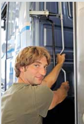
JAN BURGDORF: ruční klika usnadňuje nastavení střešního spojleru.
