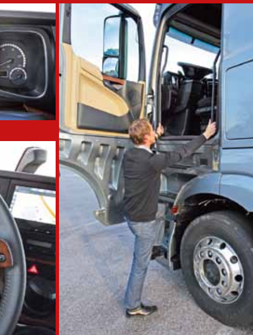
Extrémně vysoký výstup čtyřmi schody
