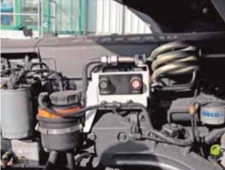
„OVLADAČ“ cizího spouštění“ na hlavě válců.
