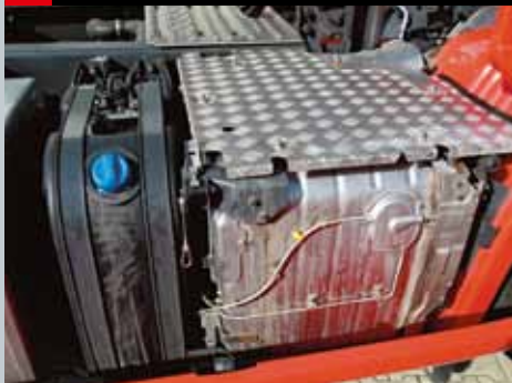
KOMPAKTNÍ chemička se soustavou SCR a DPF.
