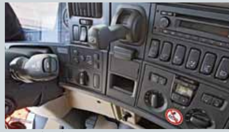
OPTIMÁLNÍ ovládání systému Opticruise páčkou pod volantem.
