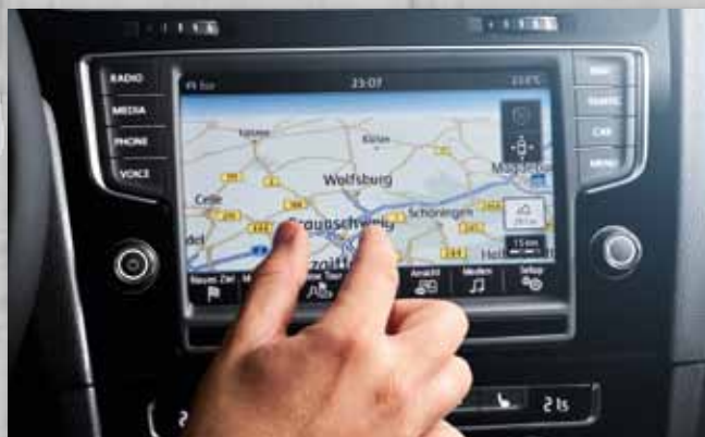
▲ Moderní multimediální systémy mají dotykové displeje s čidlem přiblížení prstu uživatele (po něm na displeji zobrazí dostupná virtuální tlačítka)
