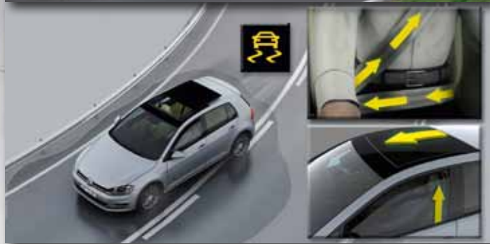
Systém PreCrash při rozpoznání krizové situace přitáhne bezpečnostní pásy a uzavře okna
